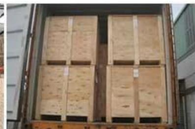
Antes del envío, la máquina se limpia por completo, se aplica cuidadosamente con aceite antioxidante, se cubre con una bolsa de plástico, se envuelve con una película de plástico y, finalmente, se coloca en la caja de madera.
