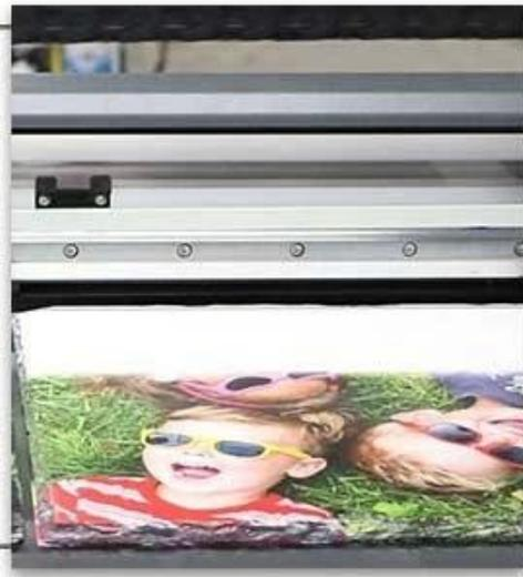
6090B 数位 UV 打印机 采用 Apex 最新 UV 打印机，具有双打印头、强力清洁、自动高度检测、水冷系统、UV LED 灯可调、等功能。
